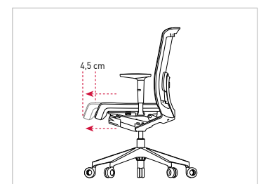
Blocage en 4 positions. Auto-retour en appuyant sur le levier et en se levant du siège
